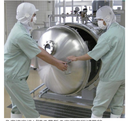
多度津高校が誇る最新の高圧減圧釜
