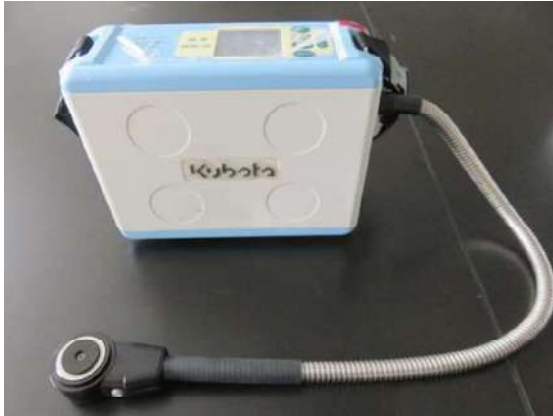
図3 フルーツセレクター (近赤外分光光度計)
