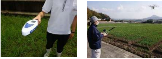
図1 センシング診断に使用した機器 (左) GreenSeeker Handheld Crop Sensor (ニコン・トリンプル社) センサーを作物から60~120cm程度上で持ち、トリガーを引いて測定。 (右) Phantom 4 Multispectral (DJI社) 6眼カメラ搭載のドローンで空撮・測定。
