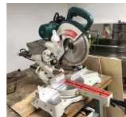
スライド丸ノコ盤 丸ノコの角度を45度まで変更可能な、傾斜装置が付いています。
