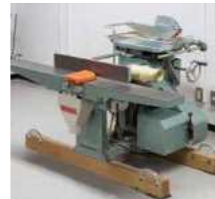
万能機 手押カンナ盤、自動カンナ盤、丸ノコ盤がひとつになったものです。1台の機械で各種作業が行えます。
