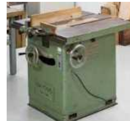
丸ノコ昇降盤 テーブル中央から丸ノコが突き出すシンプルな構造の機械です。定規に加工材を沿わせてカットします。
