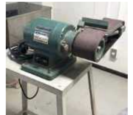
ベルトグラインダー ベルトの平面や曲面を利用して様々な材料を削ります。手作業に比べ短時間で削ることができます。
