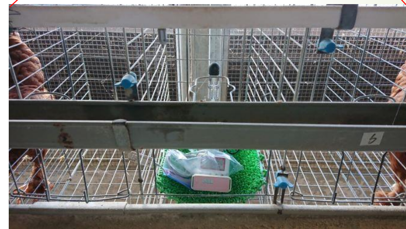
温湿度計・風速計 (高さ1.2mに設置)
