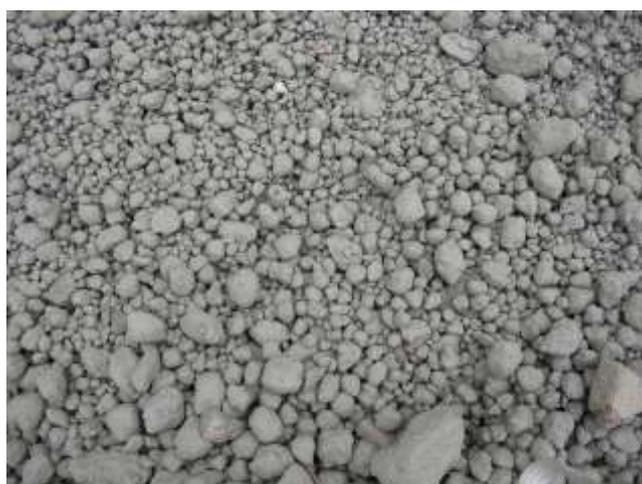
図3 充填材として使用している石炭灰粒状材
