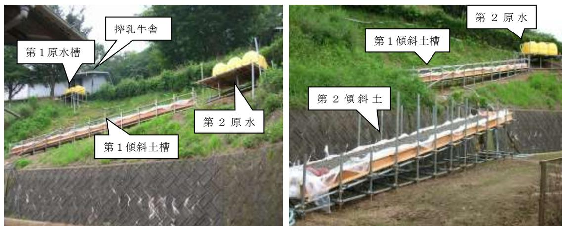
図 1 傾斜土槽法による水質浄化装置
