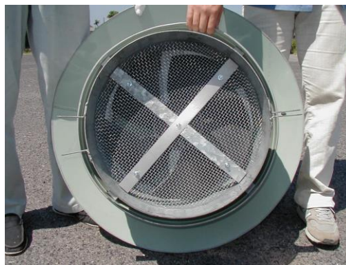
図2 かざぐるま式換気蓋内部 (5枚の換気扇)
