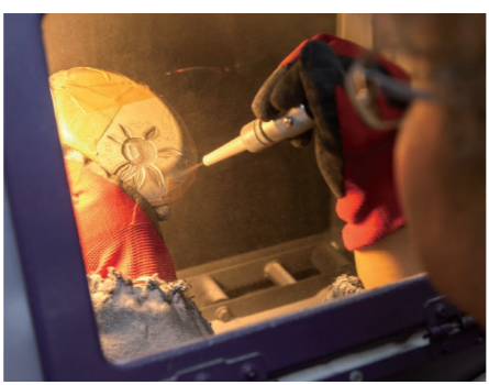
ゴムシートに線を写し、ガラス本体に貼り付け、それを細かく切り取り、最後に金剛砂と呼ばれる粉のような砂を吹き付けて彫るサンドブラストの作業風景。東條さんの場合は切り取り作業にかなりの時間を要する。
