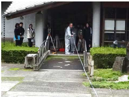
「小型レーザー距離計搭載ポケットコンパス」 「けんなわ」それぞれで距離を測定し比較
