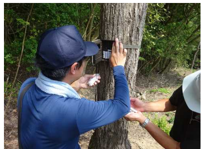
⑥ このまま撮影を続けるので、電池と記録用のSDカードを新しい物に入れ替えます。
