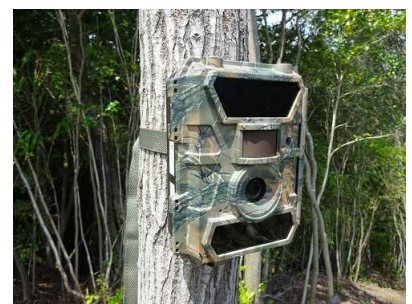
③ センサーが動物の熱を感知して、自動で撮影する仕組みです。
