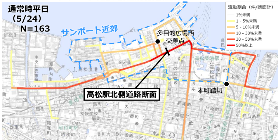
ETC2.0プローブデータによる道路利用経路 ※断面通過台数を100%としたときの流動割合を算出
