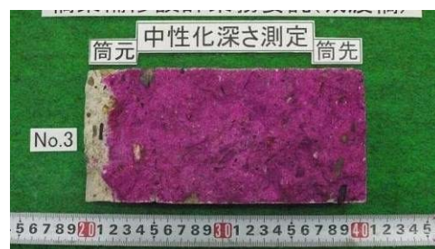
コアによる中性化深さ測定
