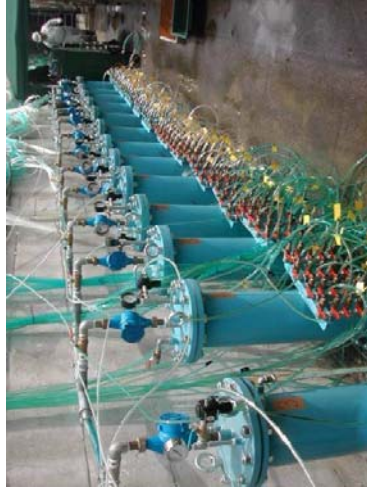
【加圧装置全景(気圧式)】
