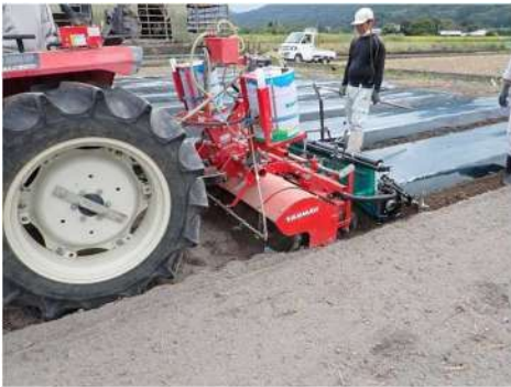
図1 畝立同時散布混和被覆機でのキルパー処理
