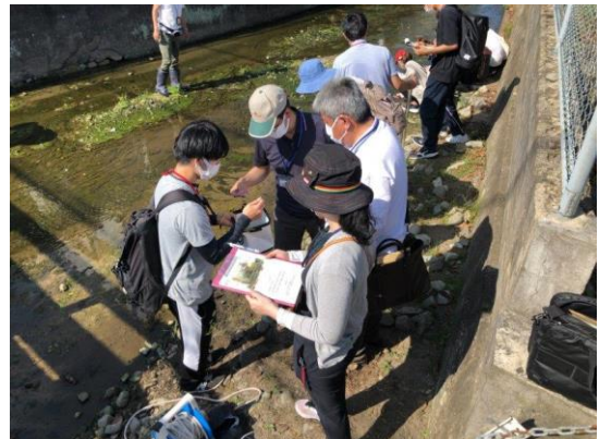
※御坊川上流域 水質検査キット「バックテスト」を使って検体と標準色を比較する様子
