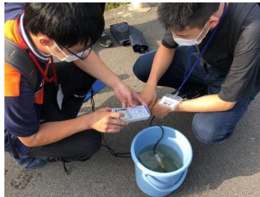
※御坊川下流域 電気伝導度を測定する様子
