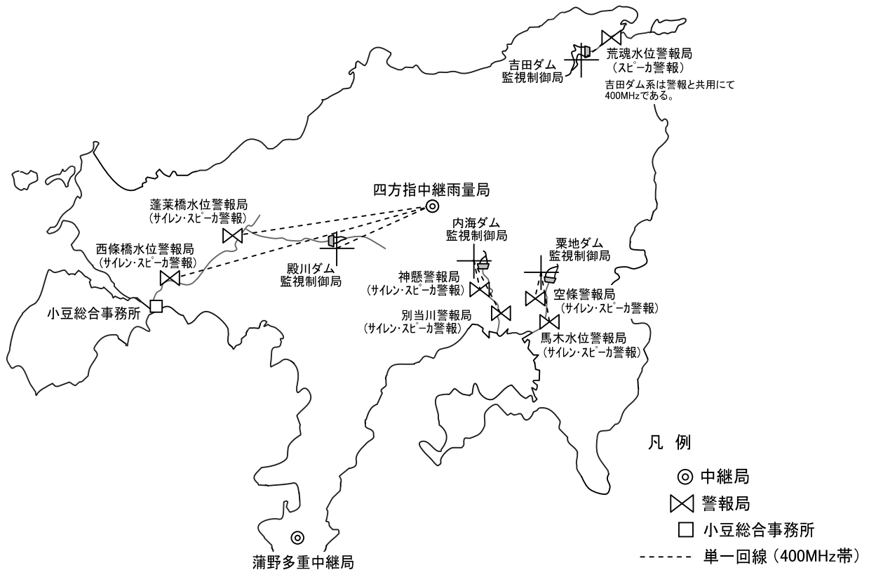
(15) 殿川・内海・粟地・吉田ダム(放流警報)系統図
