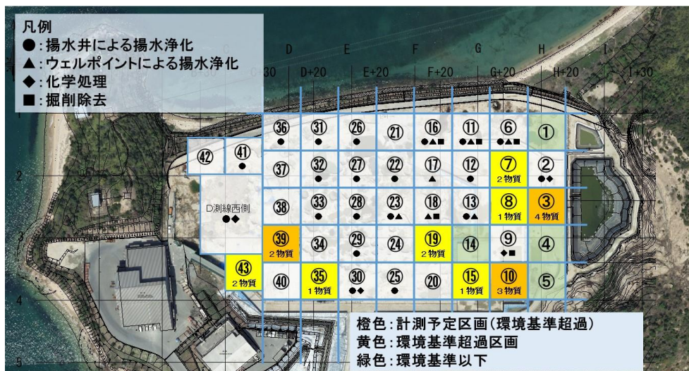
図5 各区画における浄化対策の種別と13区画のうちの環境基準超過の汚染物質数
