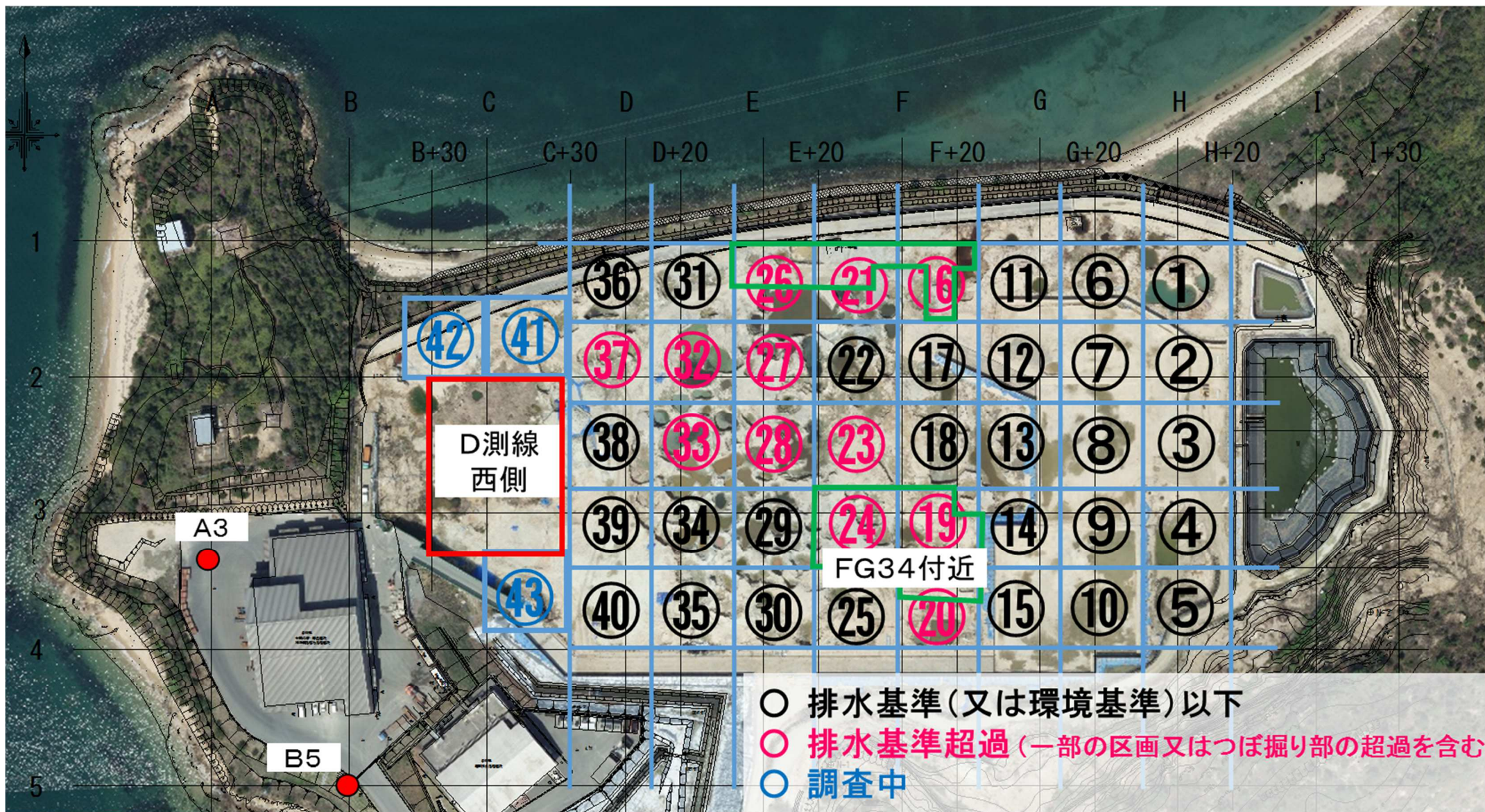
図1 処分地内の地下水汚染地点の状況
