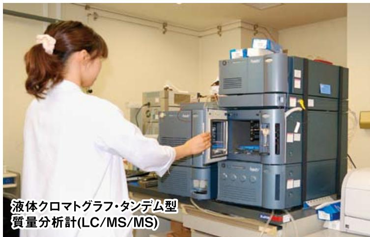
液体クロマトグラフ・ tandem型質量分析計(LC/MS/MS)
