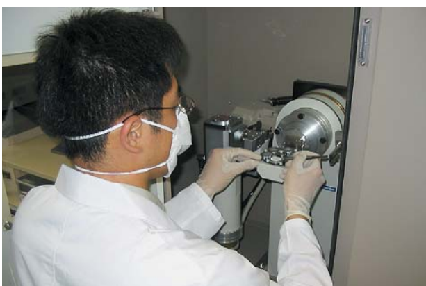
縦横 (cps) X線回折装置を用いて、吹付け材中のアスベスト含有分析を行う研究員
