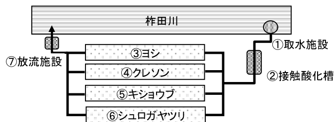
図1 水生植物を活用した水質浄化実験施設概略図
