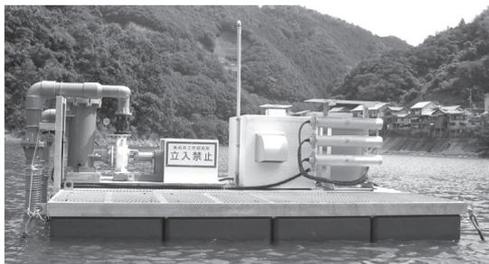
写真2 浮体部 MJS-150 型オゾン発生装置側
