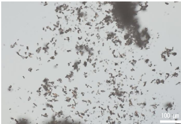
図3 粉末セルロースの顕微鏡写真 (W-10MG)
