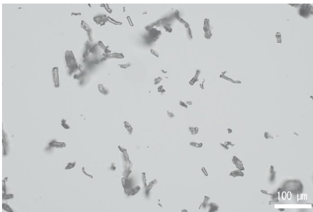
図2 粉末セルロースの顕微鏡写真 (W-400G)
