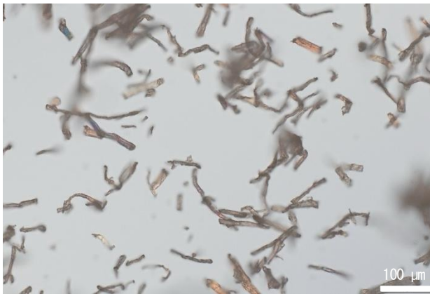
図1 粉末セルロースの顕微鏡写真 (W-50)
