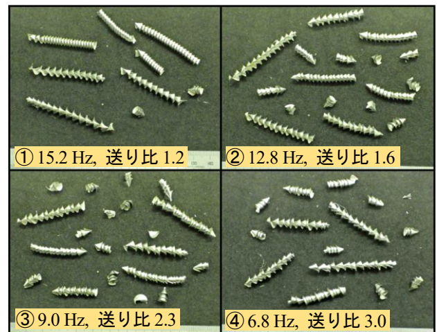
図10 切りくず（変動送り，アルミ材 A7075）
