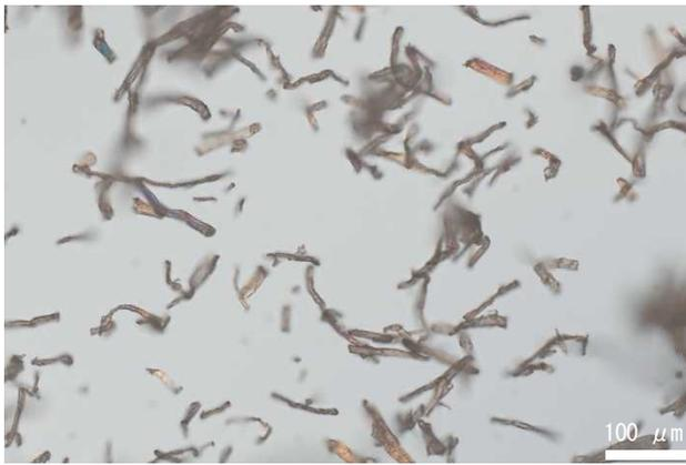
図1 粉末セルロースの顕微鏡写真 (W-50)
