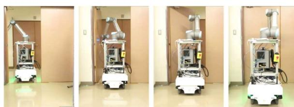
図10 提案手法によるドアの引き閉じ
