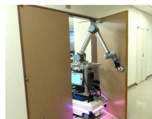
図1 モバイルロボットによるドアの押し開け
