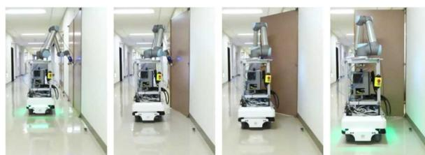
図8 提案手法によるドアの引き開け
