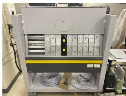
図 2 紫外線促進耐候性試験機 UV TEST
