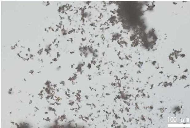
図3 粉末セルロースの顕微鏡写真 (W-10MG)
