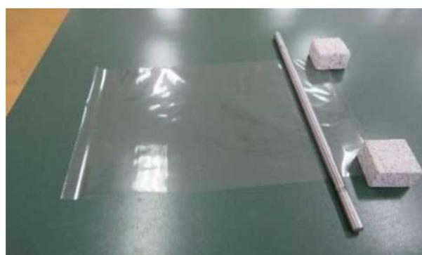
図 1 パーコーターを用いた塗工試験
