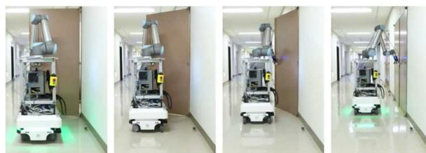
図9 提案手法によるドアの押し閉じ
