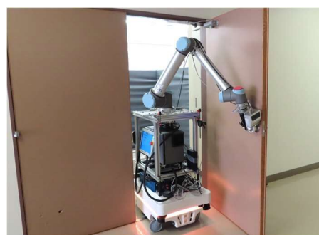
図1 モバイルマニピュレータによるドアの押し開け
