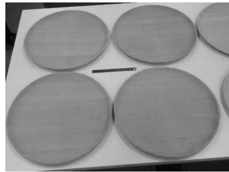
図3 県産未利用広葉樹材で試作した皿（直径36cm）
