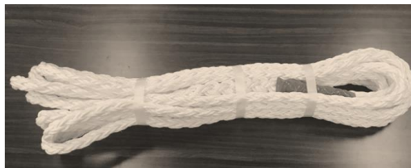
図1 検体ロープ外観（全長10m、直径12mm）
