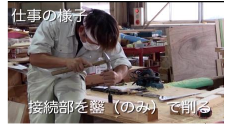
接続部を鑿(のみ)で けず 削る
