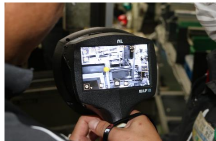
エア漏洩検出カメラの利用風景
