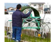
トンネル支柱打込み機
