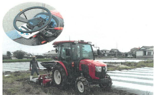
直進アシスト機能装置付（左上）トラクター
