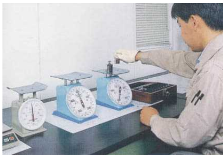
図1 ばね式指示はかりの検査風景
