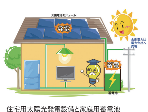
住宅用太陽光発電設備と家庭用蓄電池
