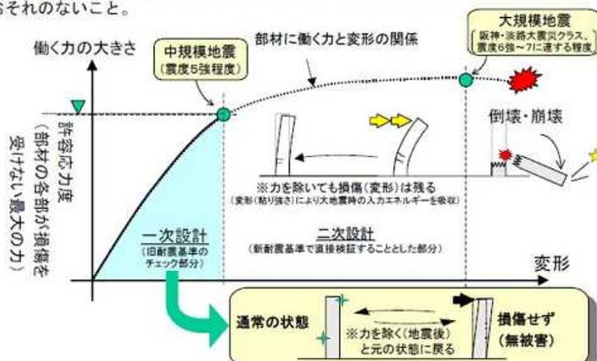
※ 二次設計には、保有水平耐力計算の他、より厳密的な許容応力度等計算やより高度な構造計算方法である限界耐力計算等がある。
