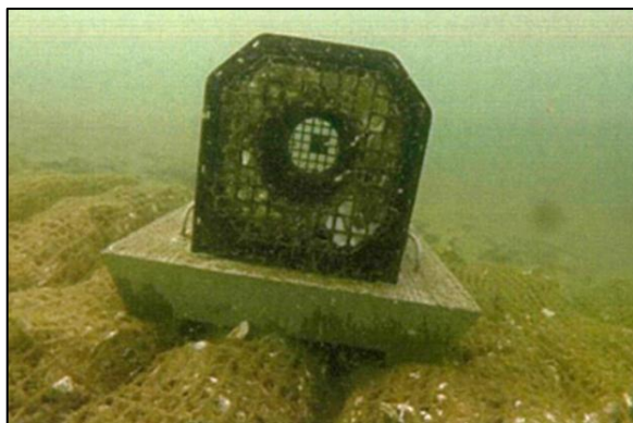
写真1 使用した基質（貝藻くん中空型）設置状況
