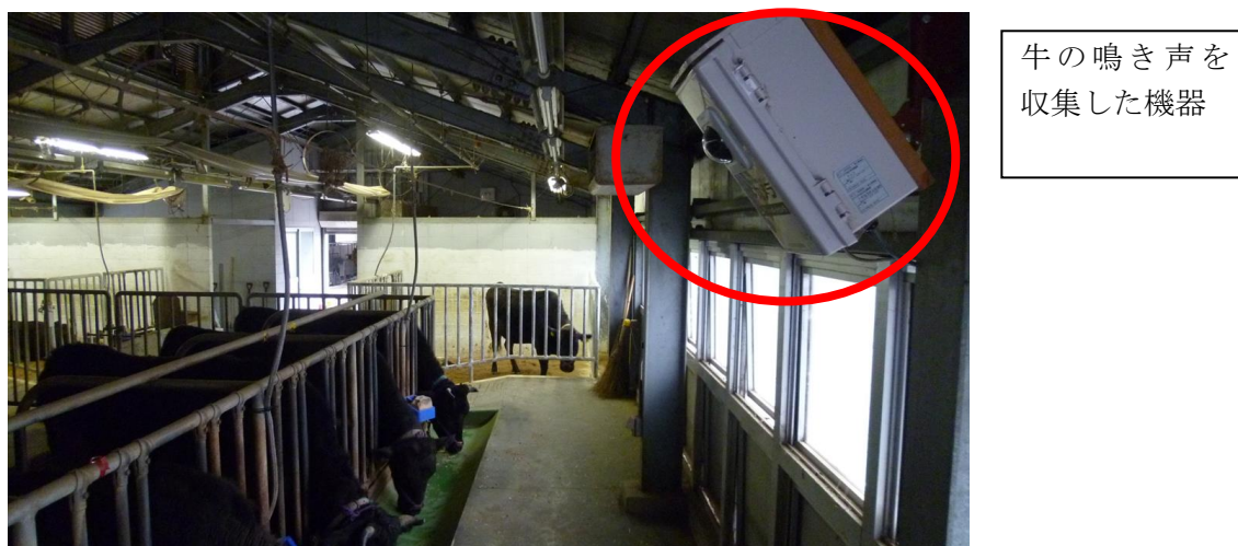
図1 牛舎内に設置した牛の鳴き声を収集した機器
