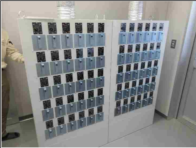
⑦ 自主検査設備 (荷受物から取得したサンプルを検査する設備。 農業者ごとに小型乾燥機で乾燥し、穀粒の品位を測定する。)
