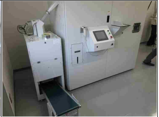
⑦ 自主検査設備 (荷受物から取得したサンプルを検査する設備。 農業者ごとに小型乾燥機で乾燥し、穀粒の品位を測定する。)
