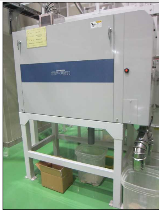
② 白米精選機 (網目の大きさが違う“ふるい網”3層により、精米した白米を「整粒」、「砕粒」、「糠玉」、「糠」に選別する。)
