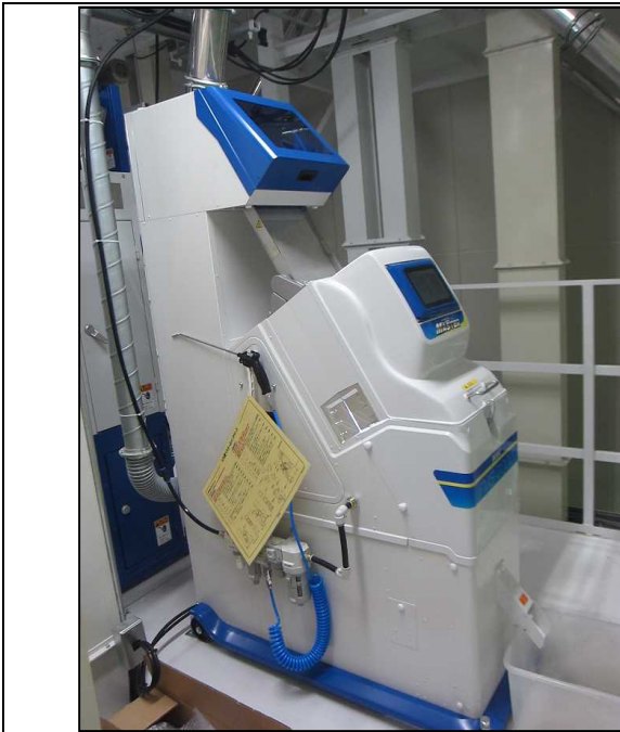
① 色彩選別機 (白米・玄米をフルカラーカメラでチェックし、着色粒や雑草種子等の異物を除去する。)
