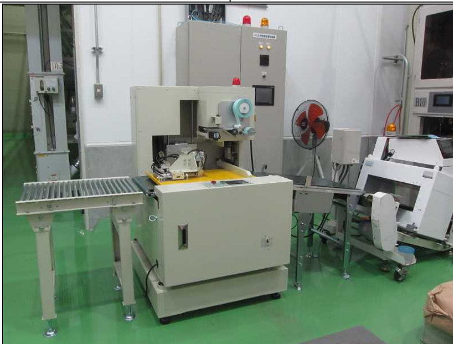
③ 全自動真空整形装置 (包装済み米袋を振動整形・密閉脱気し、真空包装のパックを作成する。密閉脱気により、空気の混入による品質低下を抑制する。)
