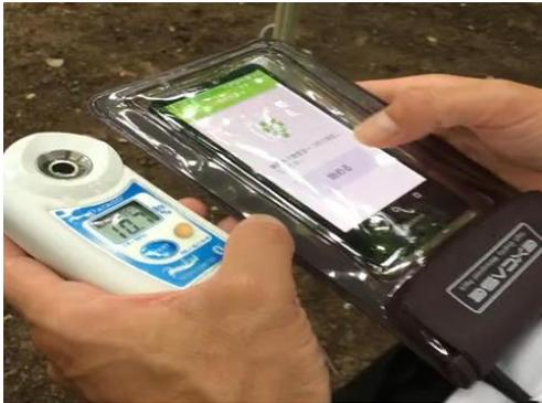
図15 タブレットと組み合わせた果実糖度の測定
