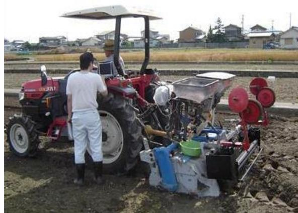
図2 衝撃式センサによる高精度肥料繰出し試験
