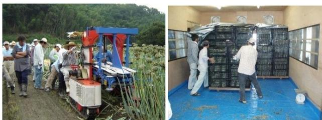
図10 採種用タマネギ収穫機(左)と除湿乾燥施設(右)
