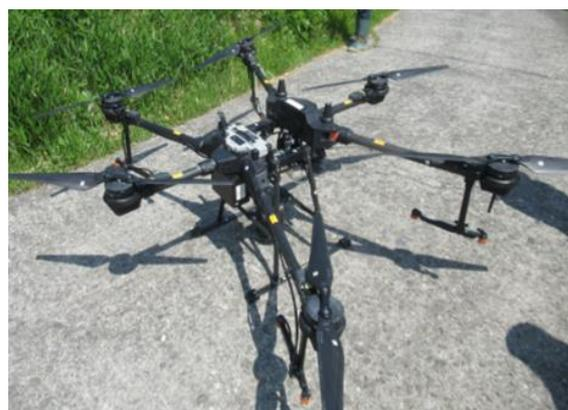
図9 農薬散布用ドローン
