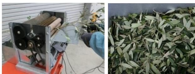
図15 オリーブ脱葉機(左)と脱葉したオリーブ葉(右)
