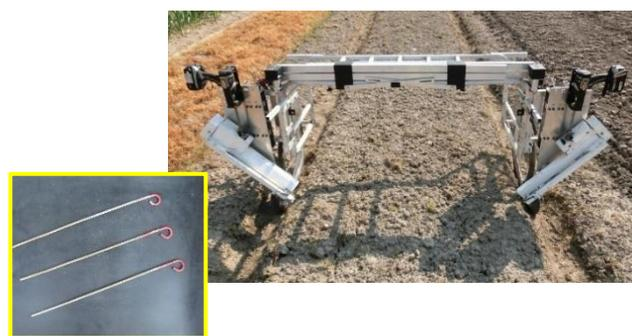
図5 試作したペグ打ち機と鉄製ペグ(左下)
