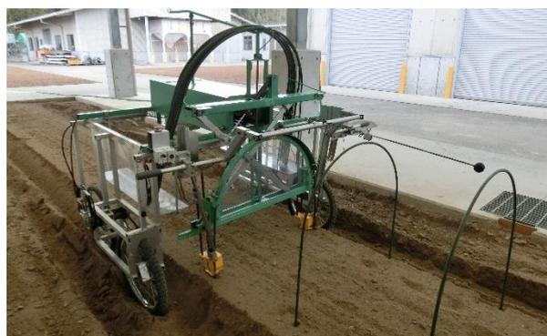
図4 トンネル支柱打ち機(新楽打の試作機)
