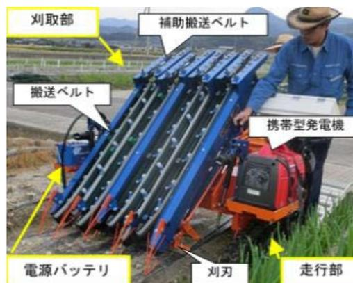
図11 加工・業務用葉ネギ収穫機
