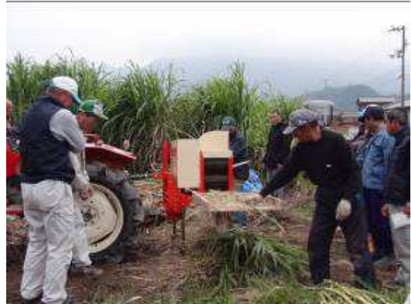
脱葉機の現地実証試験の様子
