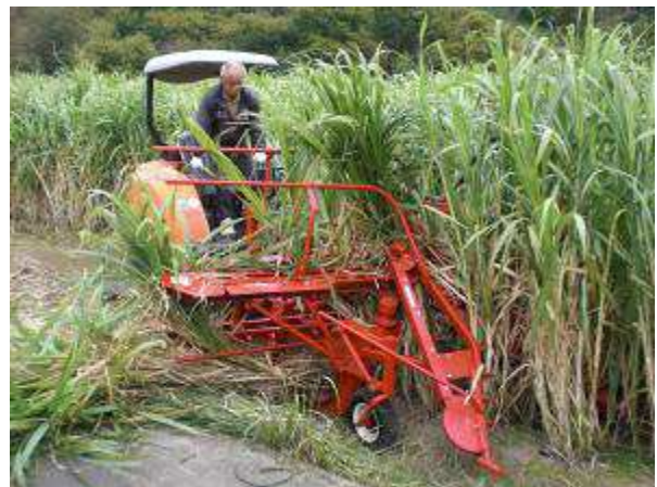
乗用刈倒機の現地実証試験の様子
