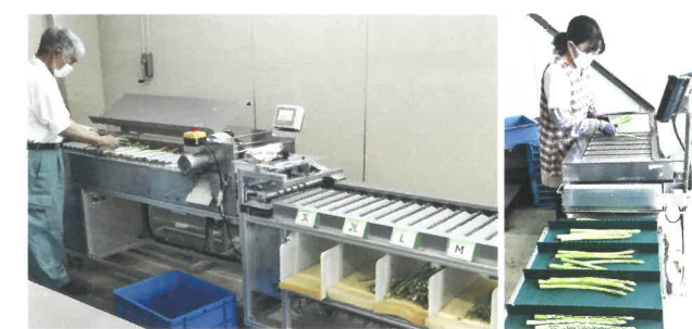
アスパラガス荷造り調整支援施設に導入された重量選別機(左)と組合せ計量機(右)
