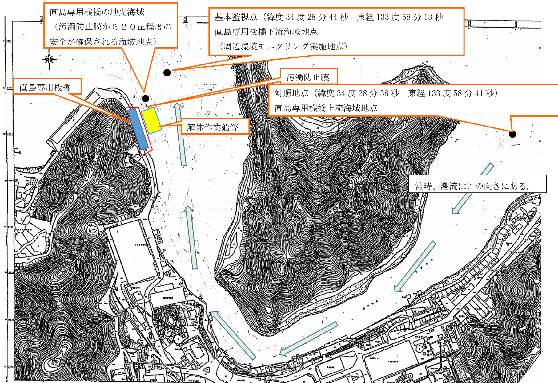
図4 直島専用棧橋と環境計測の地点と対照地点
