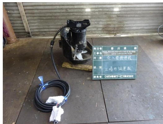
写真7 流入槽攪拌機 整備完成
