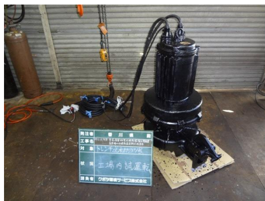
写真6 トレンチ送水ポンプ 整備完成
