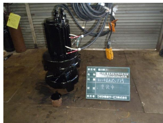
写真5 トレンチポンプ 工場整備完成
