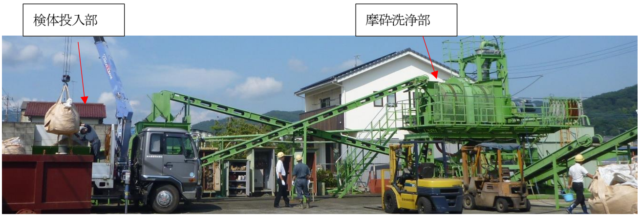
写真1 摩砕洗浄システム
