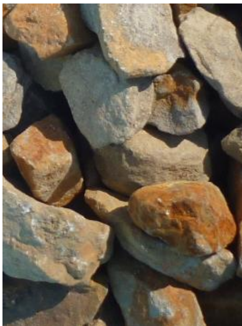
トレンチドレーン碎石摩砕洗浄処理前
