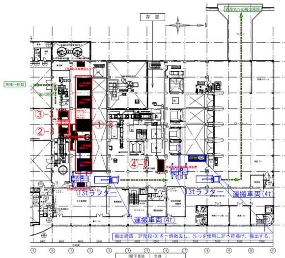
図3-15-2-4 北棟側 三階解体撤去
