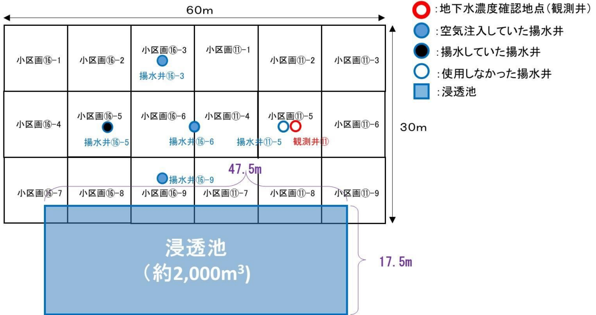
図2 HS-⑩における追加的浄化対策の状況 (R4.5~R4.9)
