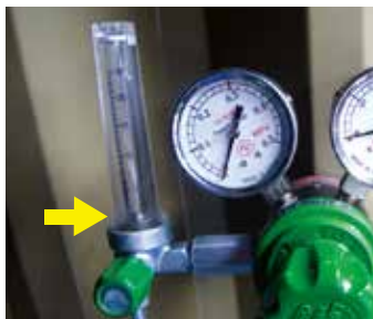
鉄球が完全に下に落ちたことを確認する
