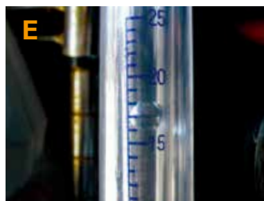
鉄球の中心を規定流量の目盛りに合わせる 写真は 17 l / min の例
