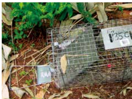
わなの内側からの衝突で ストッパーが外れた例
