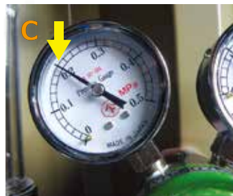
ガス圧計を 0.2MPs に設定する
