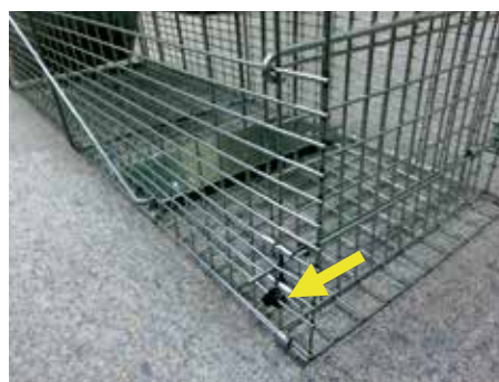
後ろ扉の可動部を、針金や結束バンドなどで補強します。
