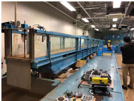
※潮流の流れを再現する大型の実験装置
