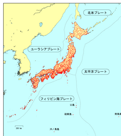
図-2 「電子基準点」(GPS連続観測点) 全国に1240点(四国99点)観測データ(1秒毎)で、点の位置変化をmm単位で監視
